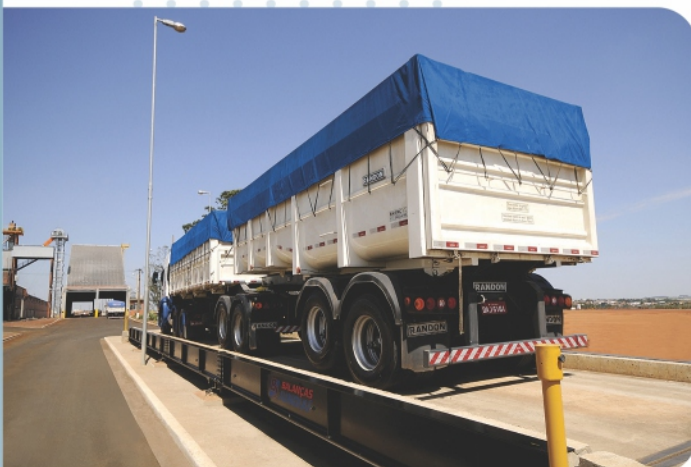
Balança sobre o piso
