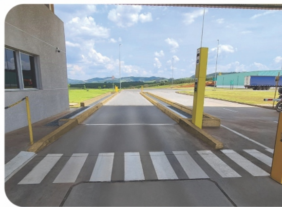
Balança semi-embutida com automação
