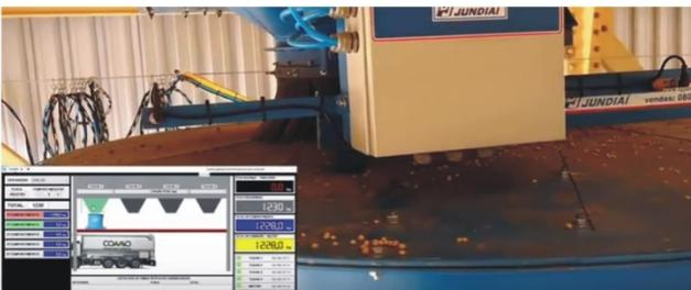
Sistema supervisório para operação remota e programação / armazenamento de dados da operação
