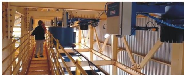
Sistema automatizado com Balança móvel sobre trilhos para atender várias bocas de alimentação
