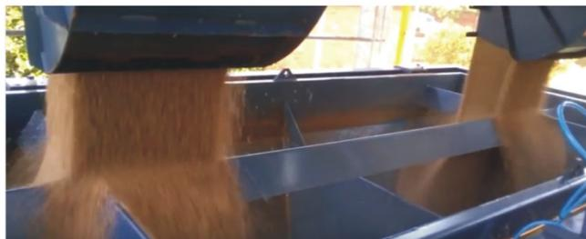
Balança de Fluxo com tulha de duas bicas para enchimento de caminhões
